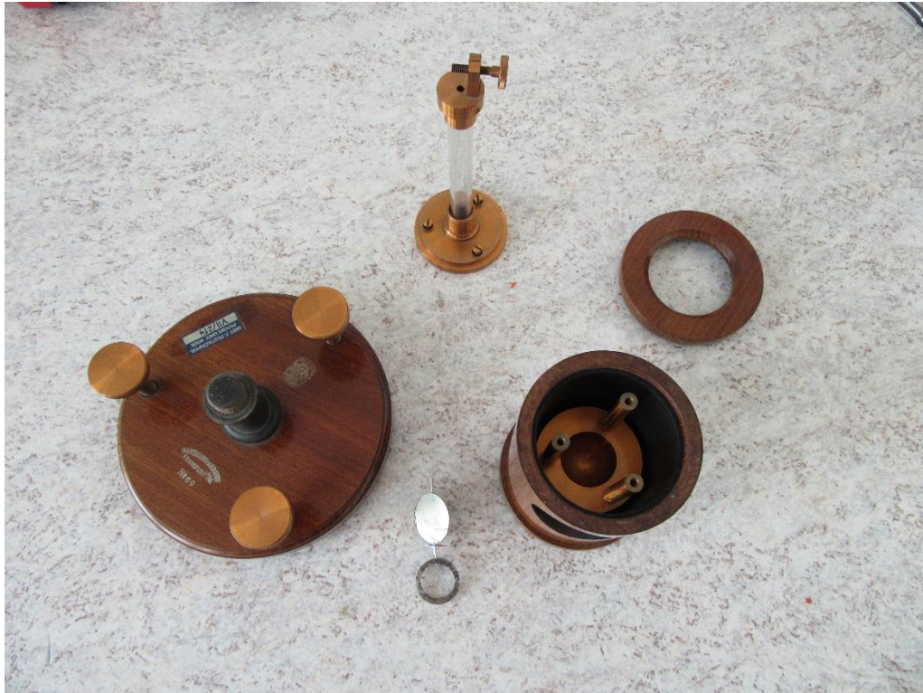
Abbildung 37: Einzelteile der Messvorrichtung – Tangentenbussole von Hartmann & Braun
