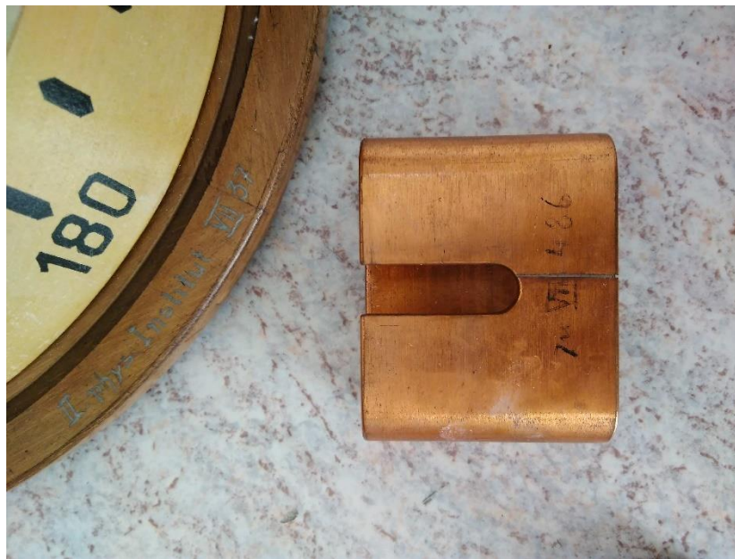
Abbildung 58: Hohler Kupferkern zur Schwingungsdämpfung
