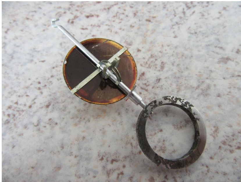
Abbildung 38: Klemmvorrichtung für den Spiegel bei der Tangentenbussole von Hartman & Braun
