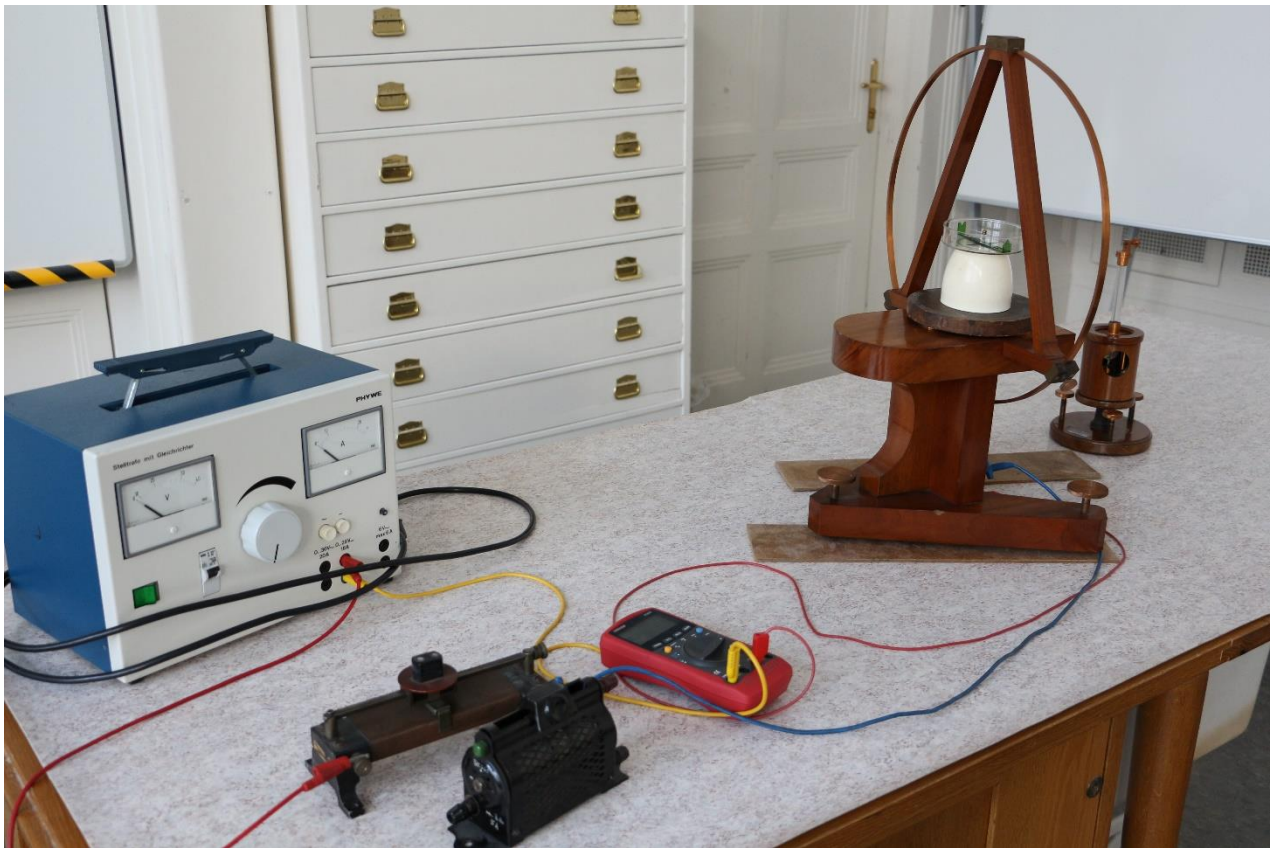
Abbildung 40: Schaltung für die Tangentenbussole von Hartmann & Braun
