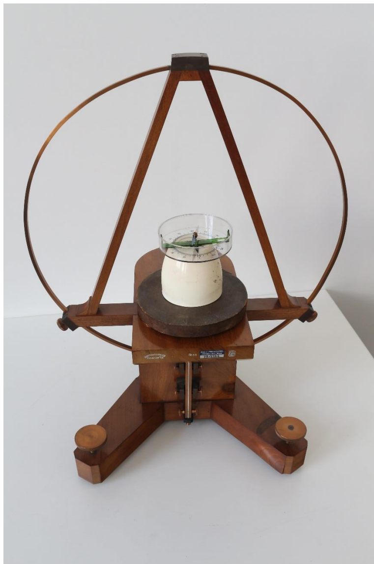
Abbildung 39: Vorrichtung mit herkömmlicher Magnetenadel – Tangentenbussole von Hartman & Braun
