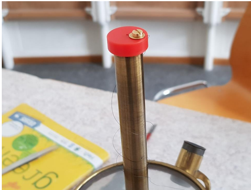
Abbildung 25: Hütchen mit Stellschraube für Positionieren der Nadel und Ausdrillen des Fadens
