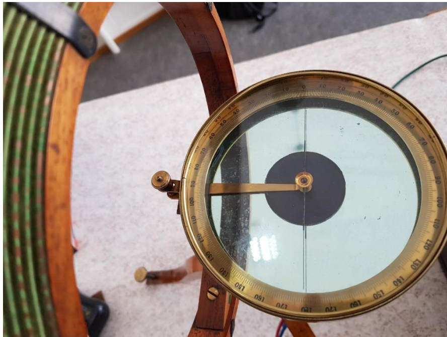
Abbildung 32: Magnetnadel und Transportsicherung - Tangentenbussole nach Gaugain
