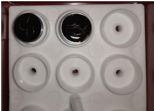
Abbildung 23 Stubs beklebt mit Kohlefolie und Flechten Querschnitten für die Elektronenmikroskopie.
