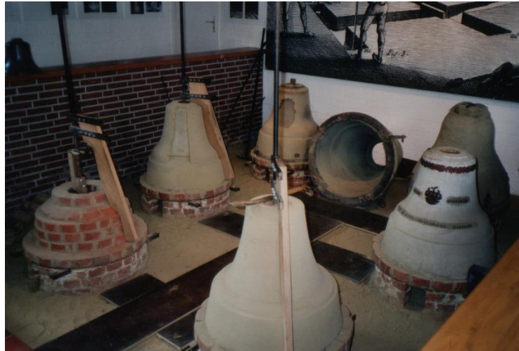
Abbildung 34 Einzelne Stadien der Glockenherstellung durch Mantelabhebverfahren (Wikipedia, 2019)
