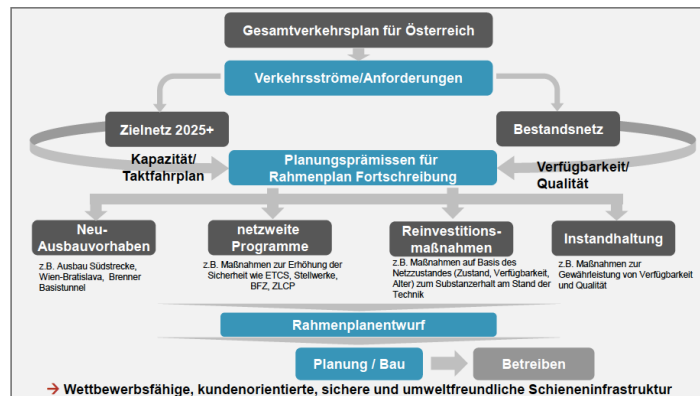
Abb. 13: Aufbau ÖBB Rahmenplan. ÖBB INFRASTRUKTUR AG 2018a, 3
