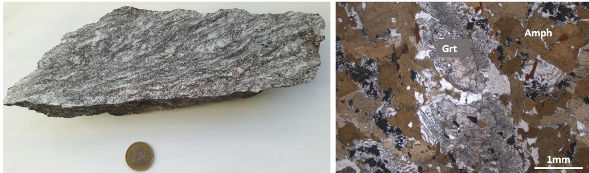
Abb. 7 Links: Handstück des Granatamphiboliths; Rechts: Amphibolitprobe unter dem Mikroskop
