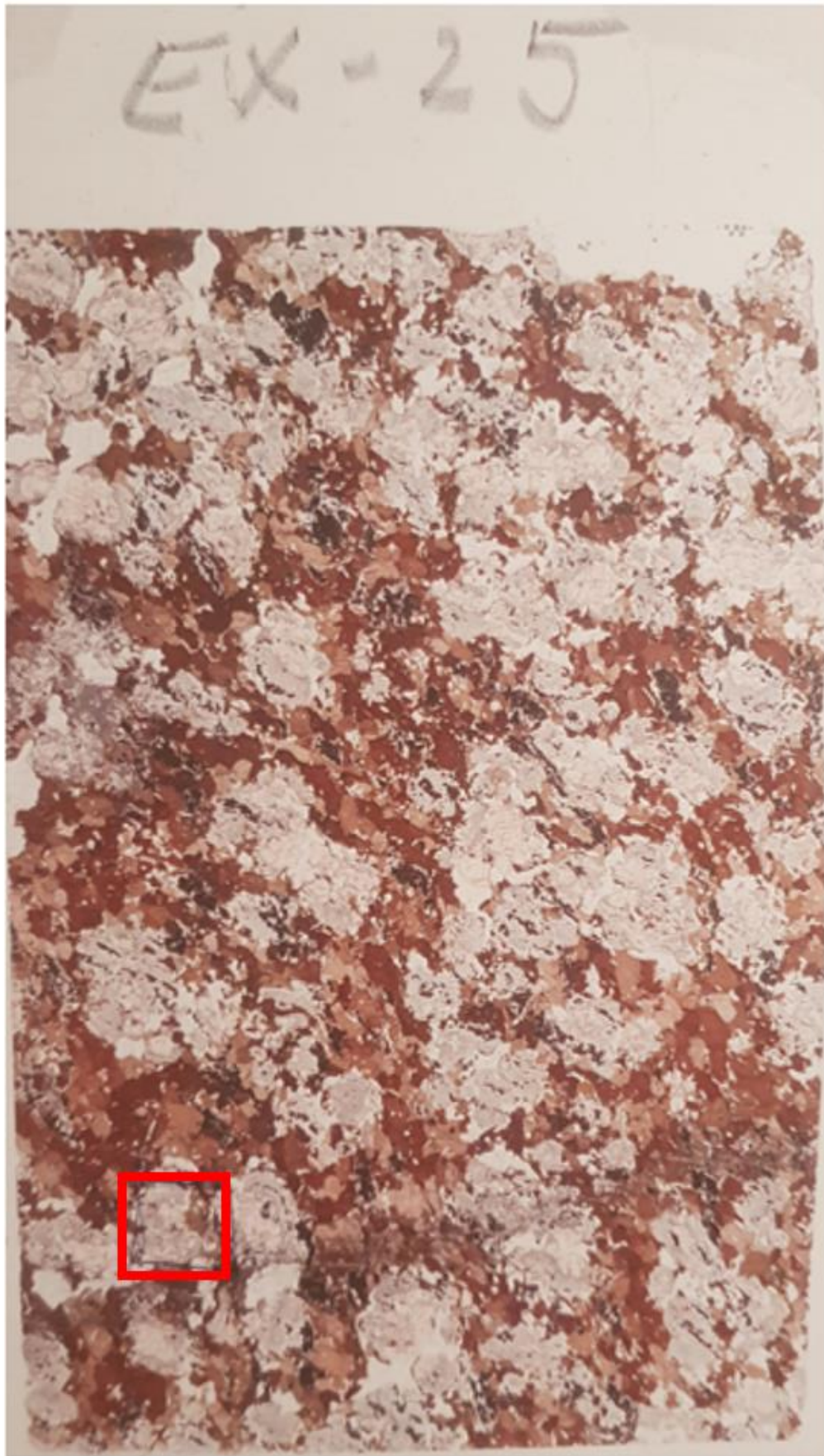
Scan des Amphibolitdünnschliffs. Rot markierter Bereich zeigt den Granat an, bei dem das chemische Profil gemessen wurde
