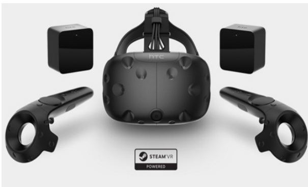
Abbildung 2: VR-Brille mit Controllern als Eingabegeräte (vorne) und Sensoren für Motiontracking (hinten) © NVIDIA
