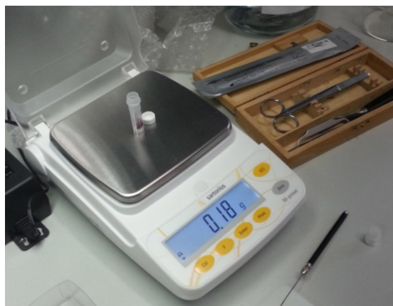
Abb. 19: Einwaage von ca. 200 mg in ein Homogenisationsröhrchen
