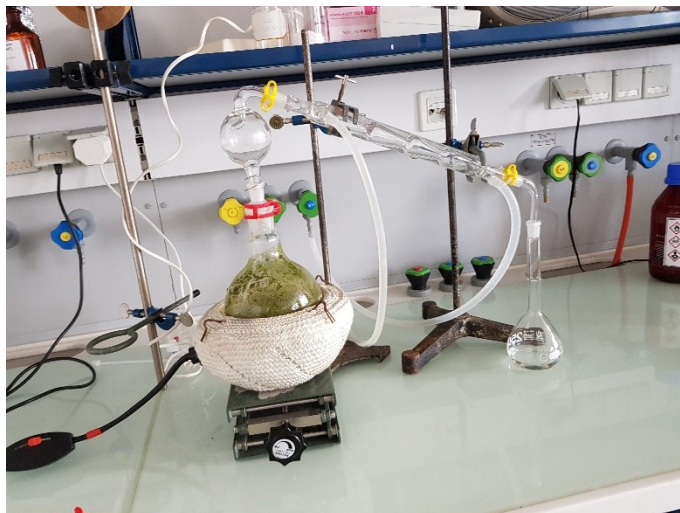
Abbildung 3 – Aufbau der Destillationsapparatur
