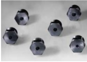
Abbildung 12: Pressdüsen in verschiedenen Größen für unterschiedliche Saaten (Anton Fries Maschinenbau GmbH 2019)
