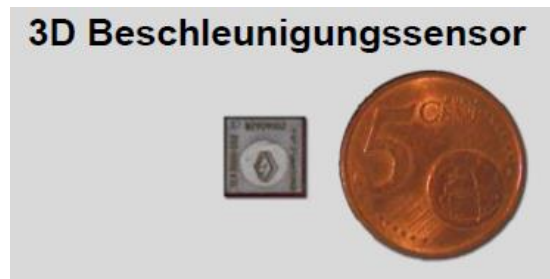
Abbildung 7: MEMS- Beschleunigungssensor (FERNANDEZ- STEEGER 2011).
