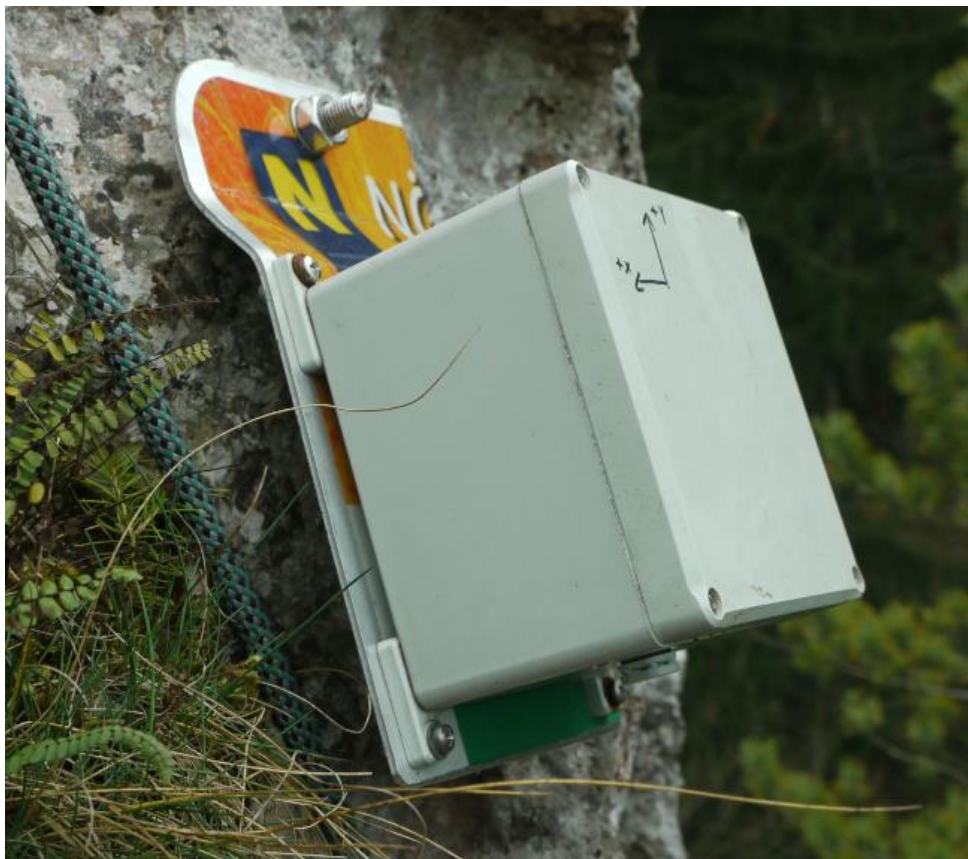
Abbildung 18: Befestigung eines Sensorknotens (Quelle: NoeSLIDE).
