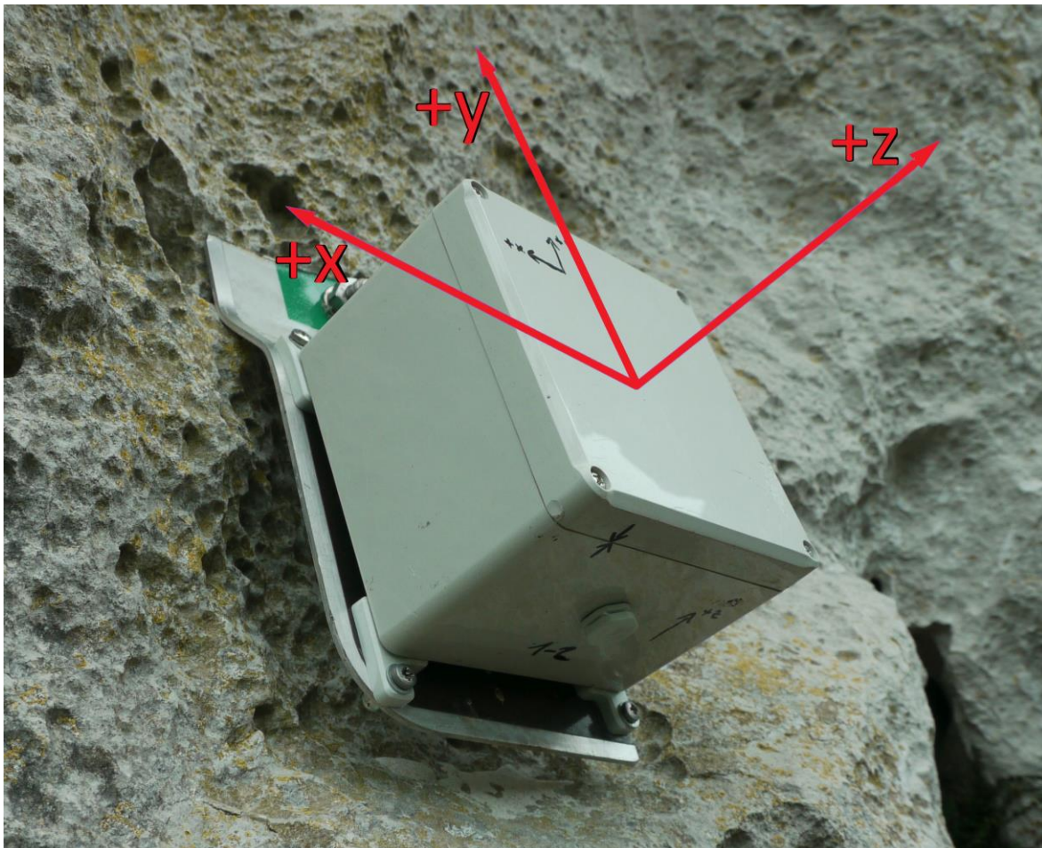
Abbildung 21: Sensorkoordinatensystem, Amtmann (Quelle: NoeSLIDE).
