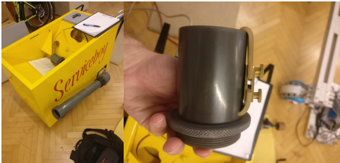
Abbildung 19 Ballkanone "Serviceboy" rechts ist der Drallaufsatz dargestellt, welcher an das Ende des Rohres im linken Foto angeschraubt werden kann. Fotos: Eigenanfertigung
