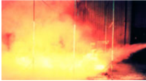
Abbildung 19: Hydrauliköl auf Schmelze (700°C)
