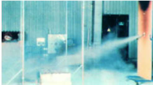
Abbildung 20: Schwerentflammbare Flüssigkeit auf Schmelze (700°C)
