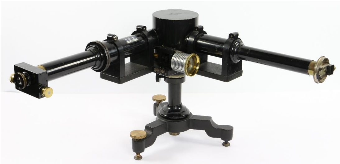
Abbildung 25: VI/90 Wellenlängenspektromat mit konstanter Ablenkung und Monochromator
