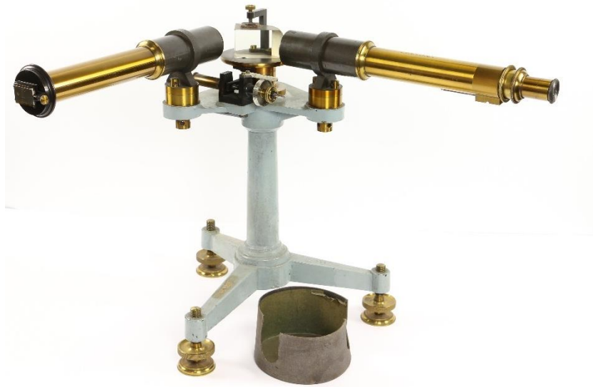
Abbildung 18: VI/31/1 Wellenlängen-Spektrometer mit konstanter Ablenkung von Hilger
