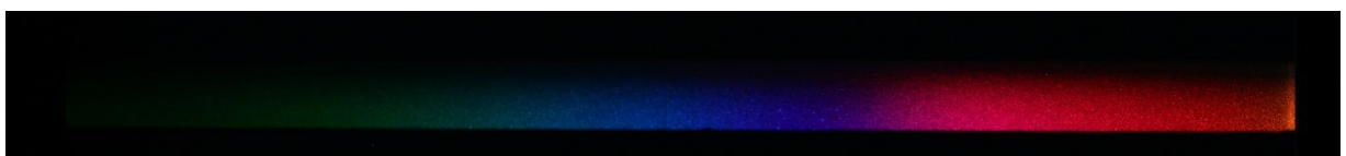
Abbildung 85: VI/214 Halogenlampen-Spektrum 3. Ordnung in Überlappen 2. Ordnung roter Farbbereich (rechts)
