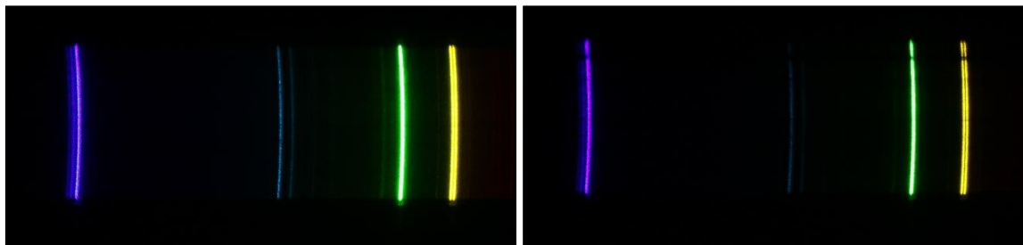
Abbildung 36: VI/252 Fotos des Kameraschirms für Hg/100 mit b=5 Skt. (links) und b=3 Skt. (rechts)
