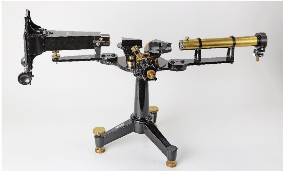
Abbildung 32: VI/252 Festarmiger Spektralapparat umgerüstet zum Spektrographen - Prismen nicht in korrekter Stellung
