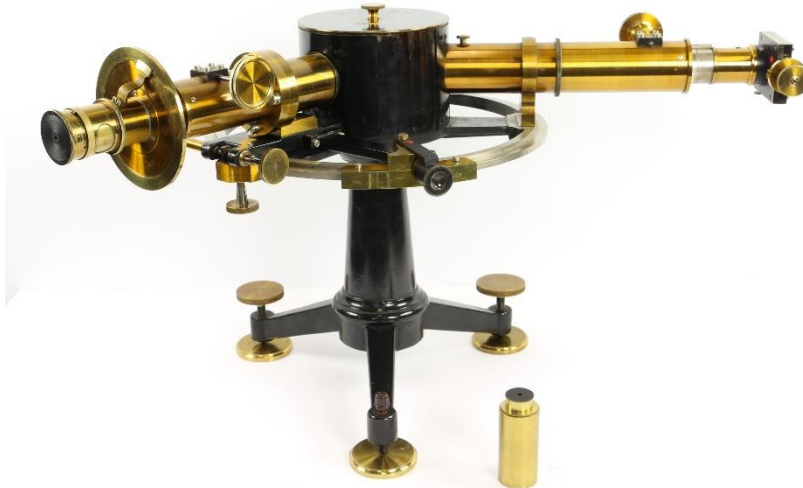
Abbildung 54: VI/22 Spektralphotometer nach König
