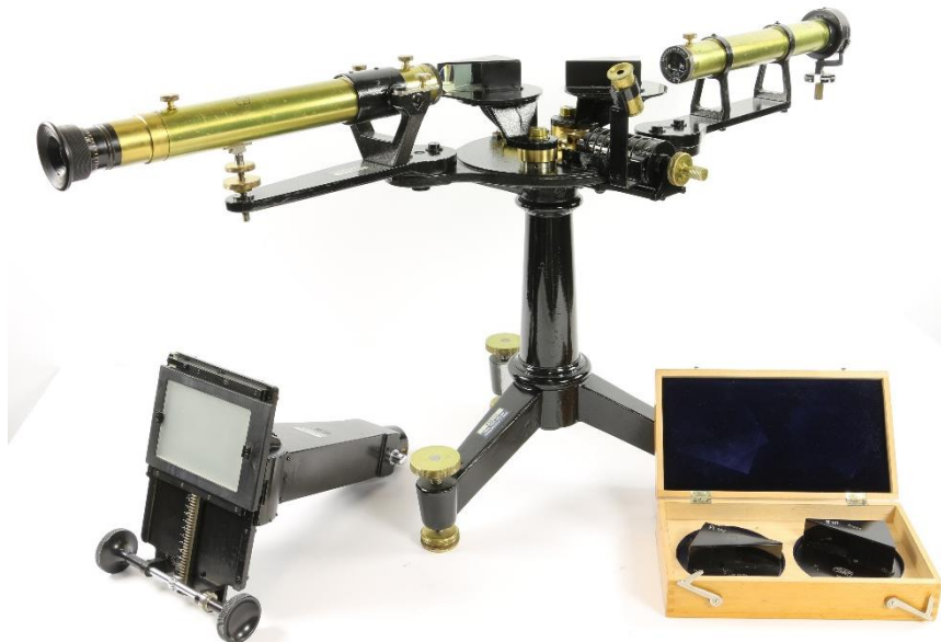
Abbildung 30: VI/252 Festarmiger Prismen Spektralapparat, wahlweise mit Kamera und zweitem Prismensatz
