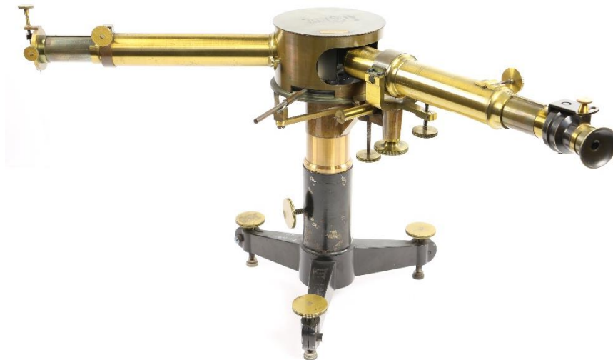
Abbildung 48: VI/47 Spektroskop mit Quarz-Prisma, Okularneigung hier ganz nach links gestellt
