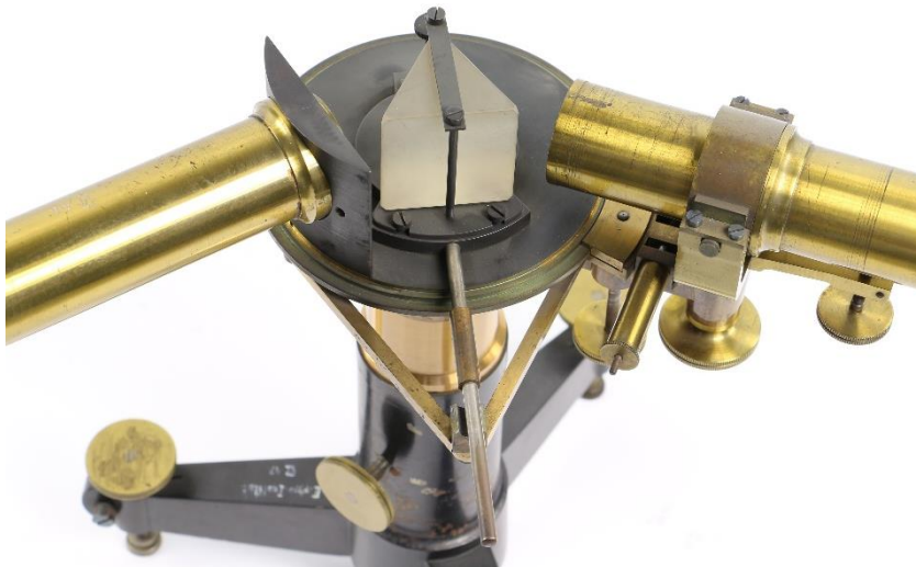
Abbildung 50: VI/47 Prismentisch nach demontierter Blende
