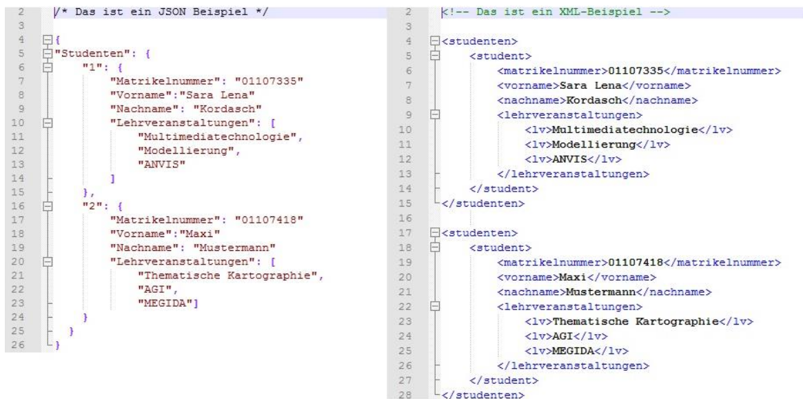
Abbildung 31: JSON vs. XML Datenstruktur (eigene Darstellung)
