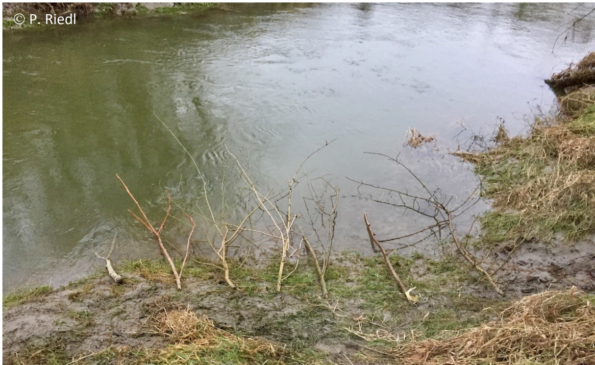
Abb. 3: Versuchsaufbau am Standort Schönau an der Donau. Deutlich zu erkennen, sind die sieben auf Draht aufgefädelten Zweige, die an der Wasserkante am Ufer ausgelegt sind.
