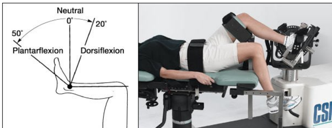
Abbildung 4.2: Dynamometer-Anordnung zur Messung der Dorsal- bzw. Plantarflexion; Quelle: http://www.csmisolutions.com/products/isokinetic-extremity-systems/humac-norm/patterns-gallery
