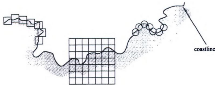
Abbildung 26: Bestimmung der Boxdimension einer Küstenlinie. 56
