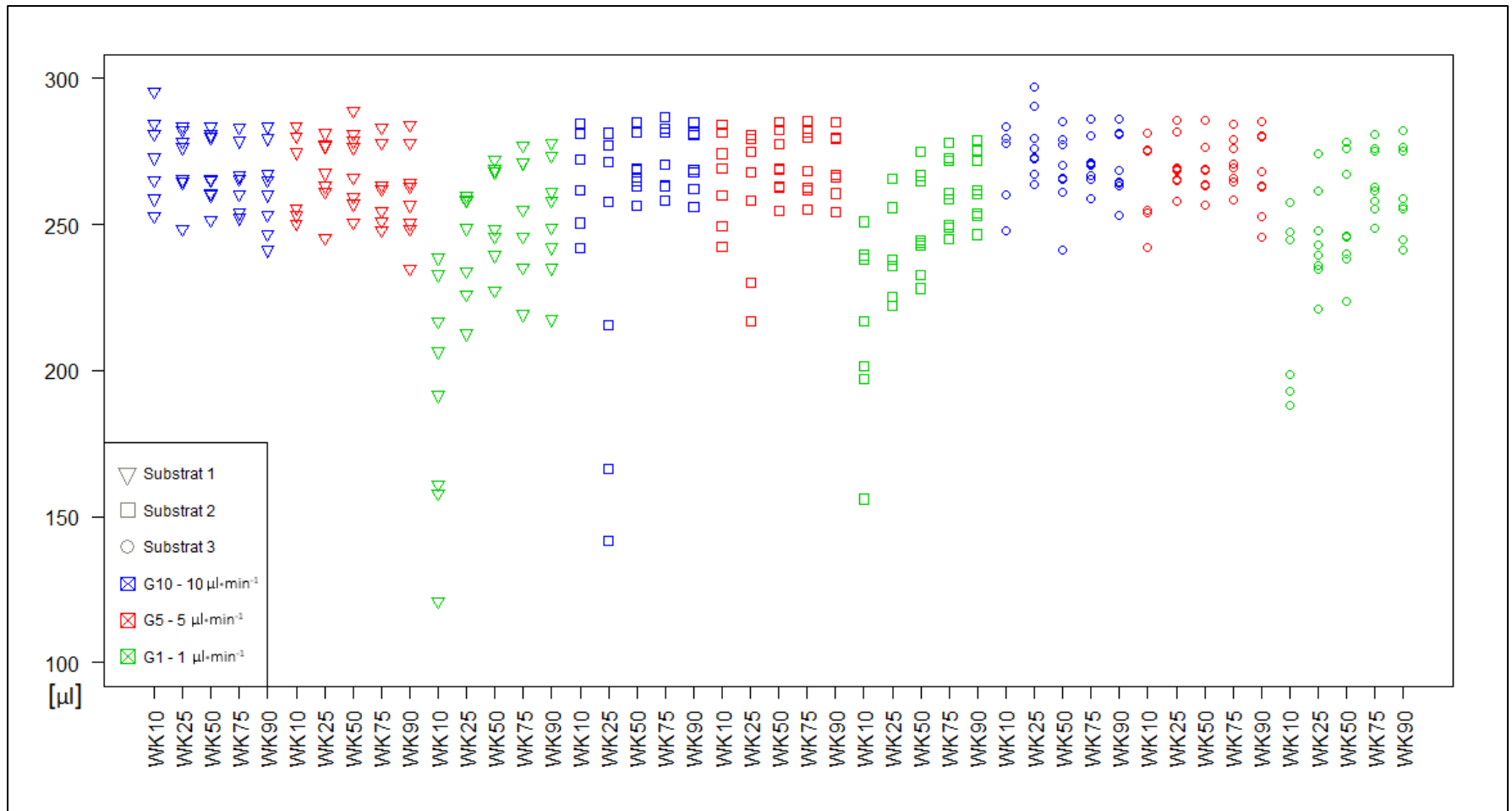
Abbildung 4: Probevolumen nach Experimentgruppen. Auf der x-Achse sind die Wassergehaltstufen und auf der y-Achse die Probevolumina (in \mu\text{l} ; gravimetrisch bestimmt) eingetragen. Das Zielvolumen war in allen Fällen 300 \mu\text{l} und wurde durch die Probenahmedauer bestimmt ( 30 \text{ min} bei 10 \mu\text{l min}^{-1} Pumprate, 1 \text{ h} bei 5 \mu\text{l min}^{-1} , 5 \text{ h} bei 1 \mu\text{l min}^{-1} ). WK10, WK25, WK50, WK75 und WK90 stehen für 10, 25, 50, 75 und 90% der maximalen Wasserkapazität.
