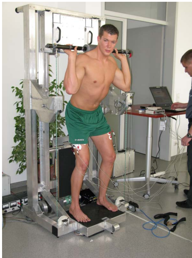
Abb. 16: Kniebeugen am MDS (Die Aufnahme stammt von Voruntersuchungen in deren Rahmen eine Elektromyographie durchgeführt wurde)
