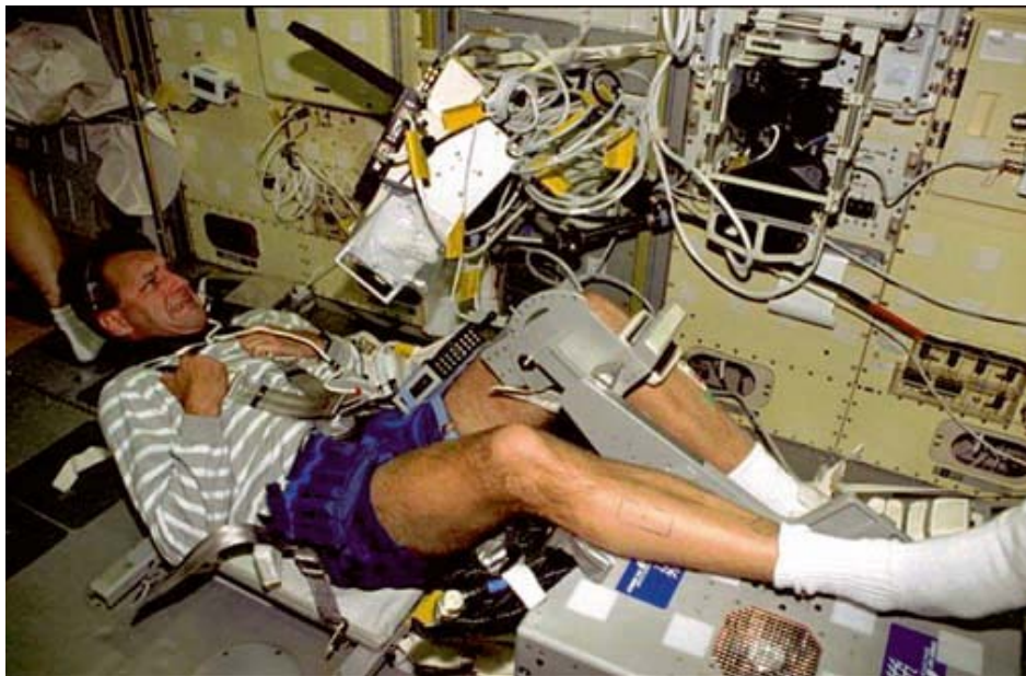
Abb. 3: Muskelfunktionstest am "percutaneous electrical muscle stimulator and torque-velocity dynamometer" während der STS-78 Mission (Narici et al., 2003, S277)
