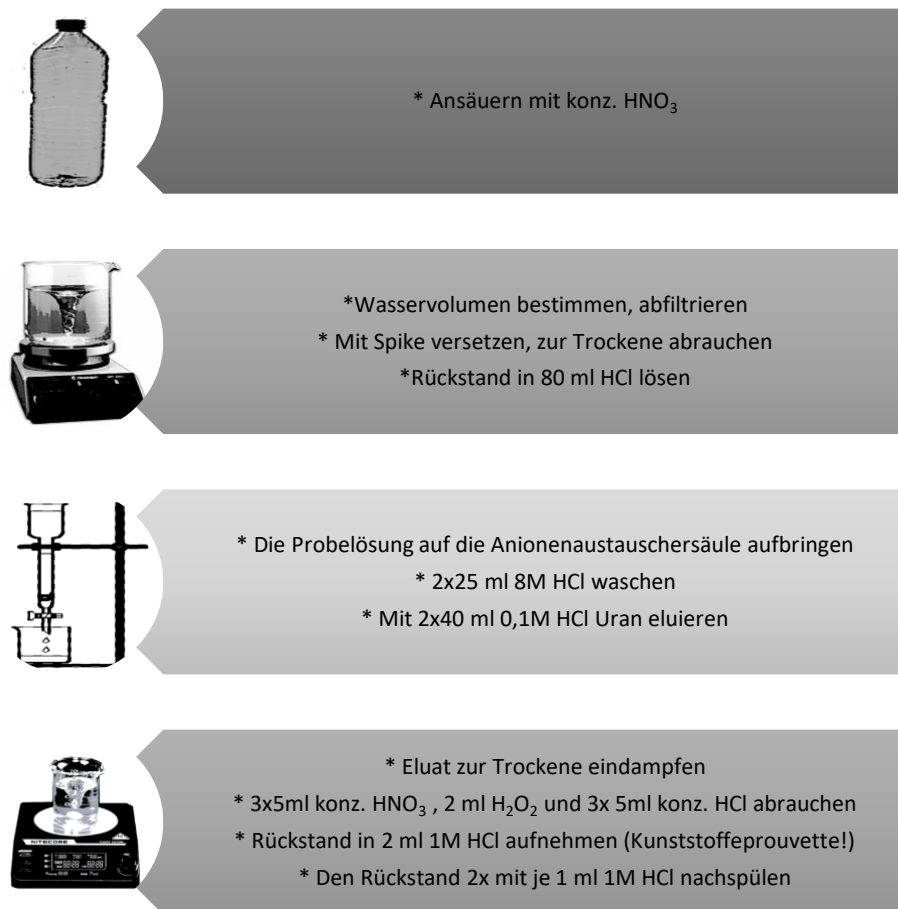
Abbildung 4: Uranbestimmung in Wasserproben
