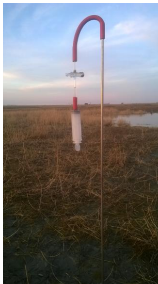
Abbildung 3: Probeentnahme Gerät für Porenwasser
