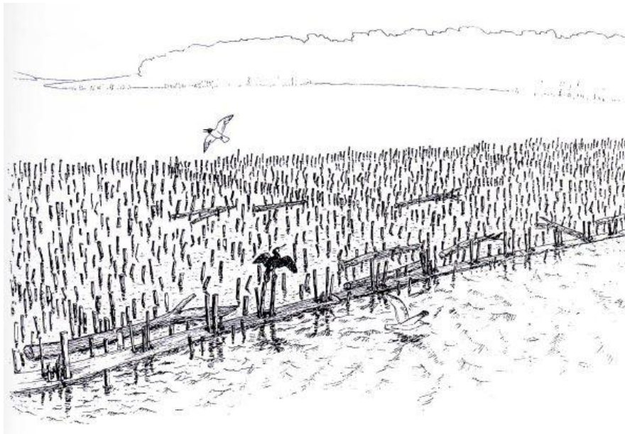
Abb. 35: In den Boden gerammte Pfähle, um einen Meeresabschnitt unpassierbar zu machen 495
