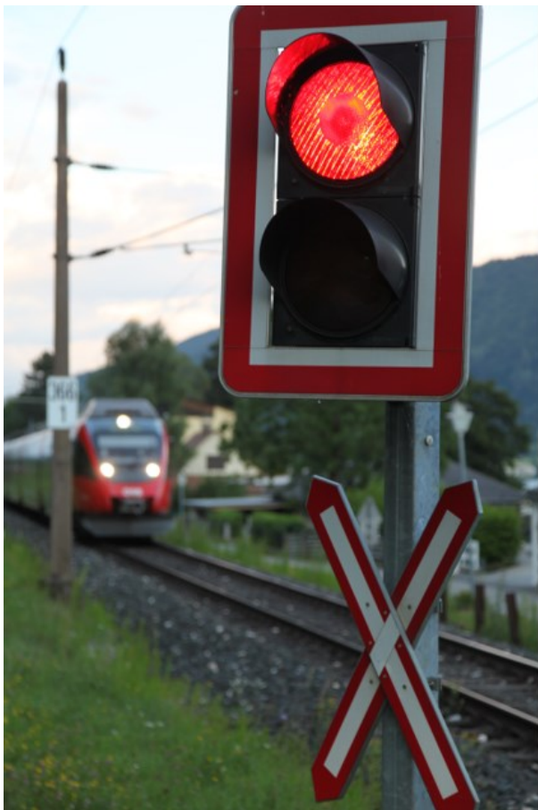
Abb. 14a: Lichtsignal zur Sicherung einer Eisenbahnkreuzung,
