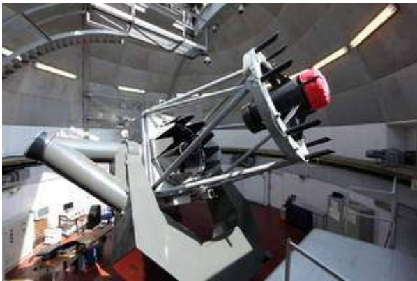
Abbildung 70 – 1.5m-Spiegelteleskop und dessen instrumentelle Daten 30
