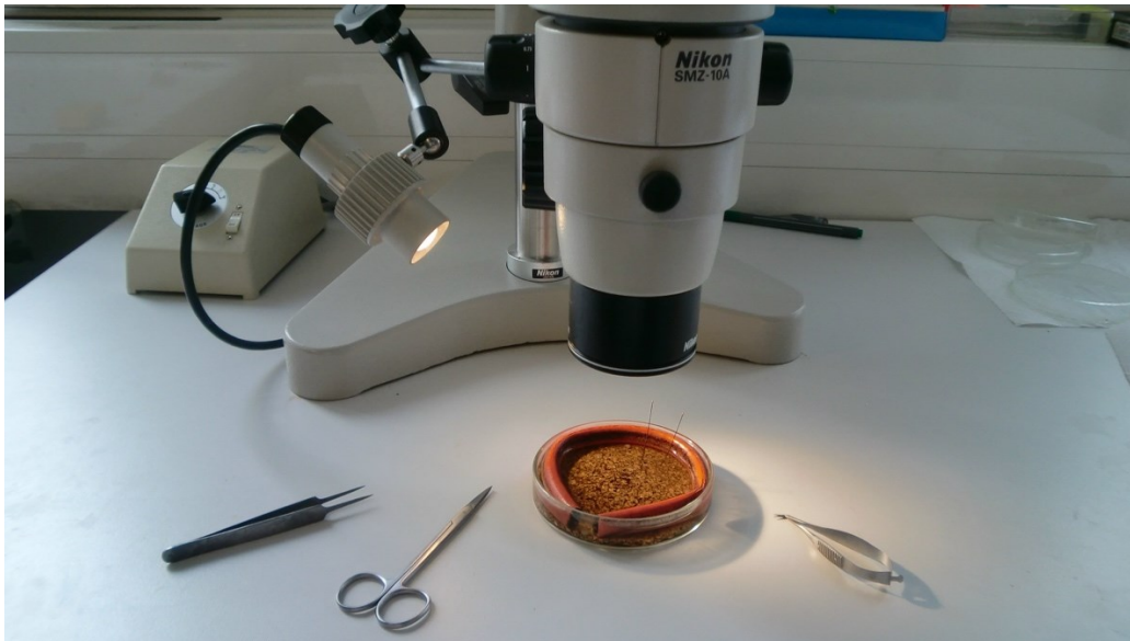
Abbildung 3: Lichtmikroskop, Präparations-Werkzeug, Petrischale mit Korkschicht
