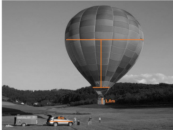
Abbildung 3: Ermittlung der Abmaße des Ballons durch Vergleichen mit bekannten Längen
