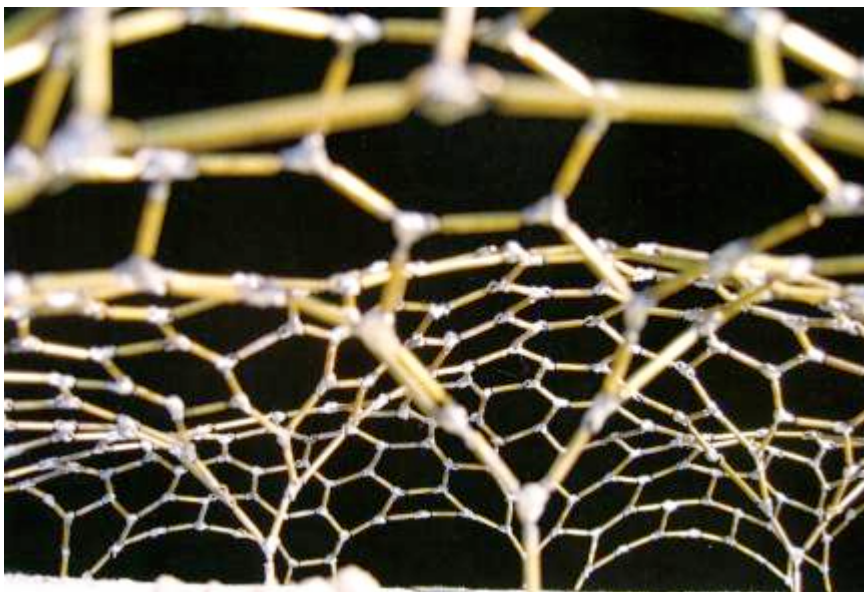
Abb. 45: Messingnetz verstärkt, Modell Nr. 4, Atelier Warmbronn 1997
