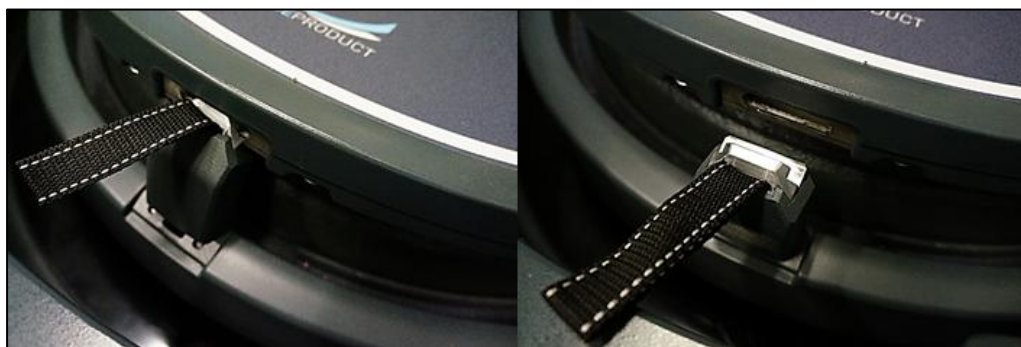
Abb. 16: Fixierungsvorrichtung der Sensorplattform (links: Kipphebel eingerastet, rechts: Kipphebel gelöst) (Sense Product, 2016, eigene Darstellung)
