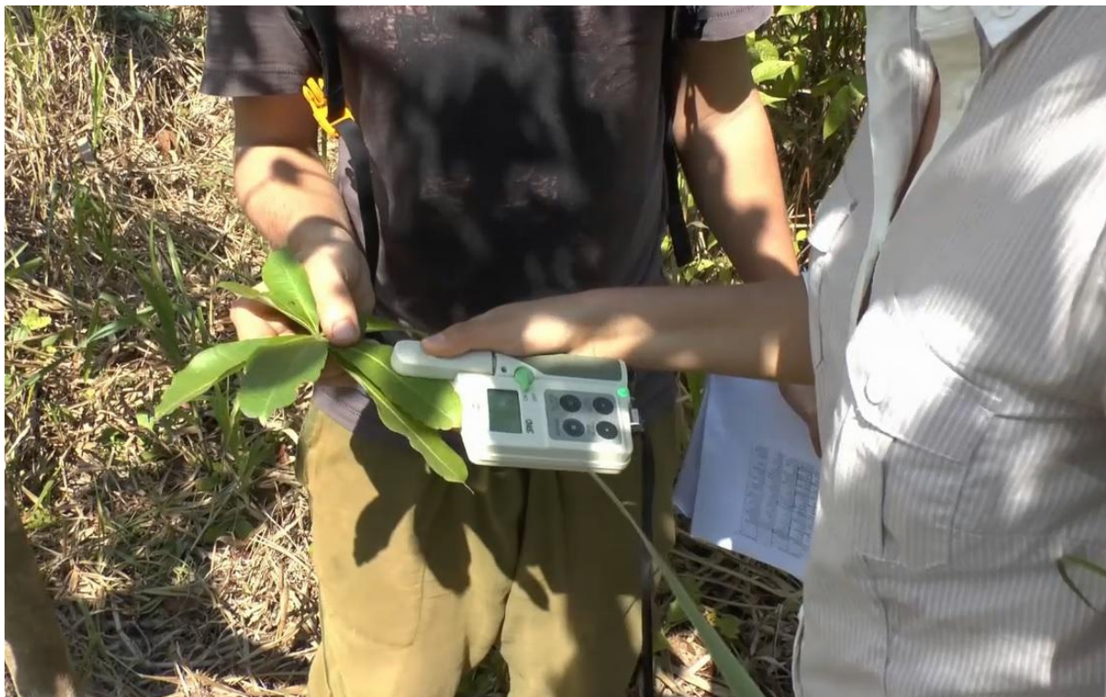
Abbildung 11 – Messung im Feld mit dem Gerät SPAD.
