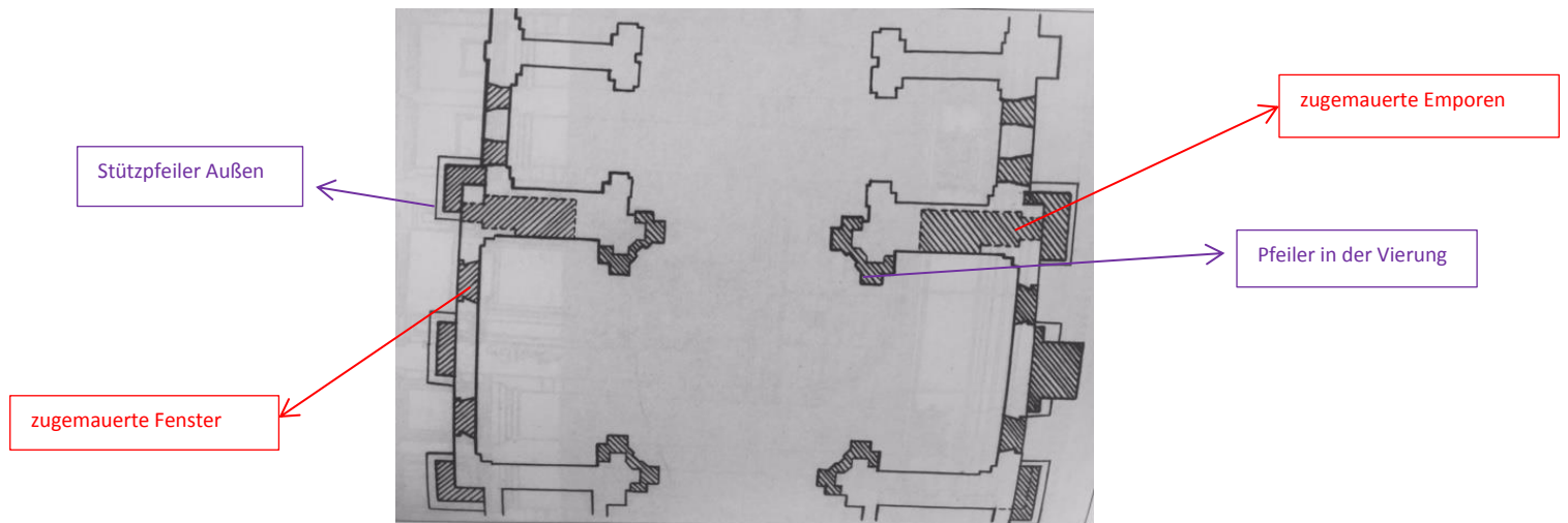
Abb. 68. Stabilisierungsmaßnahmen, die von Trevano durchgeführt wurden. Zumauern der Emporen und Fenster, Stützpfeiler außen und innen am Transept der SS. Peter und Paul Kirche, Krakau.
