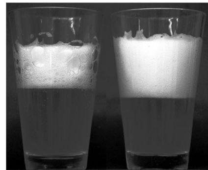
Abbildung 20 - Bierschaumzerfall in einem leicht eingefetteten Glas (links) und einem sauberen Glas.
