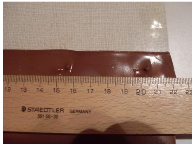
Abbildung 11 – nach kurzer Zeit in der Mikrowelle entstehen Hot Spots in der Schokolade
