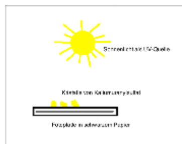
Abb. 1.4: Darstellung des Versuchs von H. Becquerel
