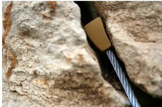
Abbildung 9: Klemmkeil (modifiziert nach Scharrer, 2011)
