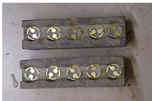
Abbildung 7: Fertige QCM mit Goldelektroden
