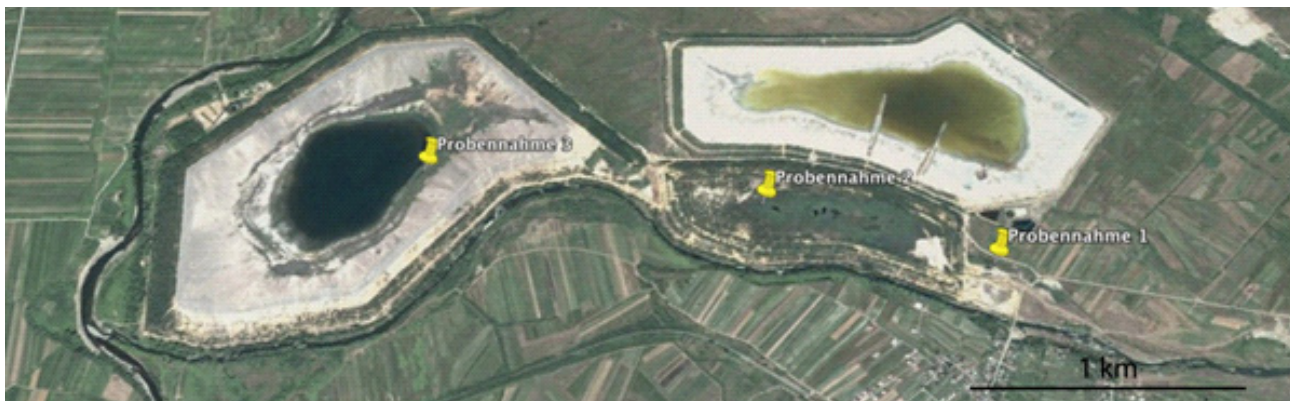
Abbildung 4: Überblick über den Haldenkomplex bei Baia Mare; NH ist bei der Probennahme 1, OH bei Probennahme 2 und UR bei Probennahme 2. Links im Bild ist der Fluss Săsar zu sehen, in den sich im Jahr 2000 auslaufende Cyanidlösung ergoss. Nach Google Earth.
