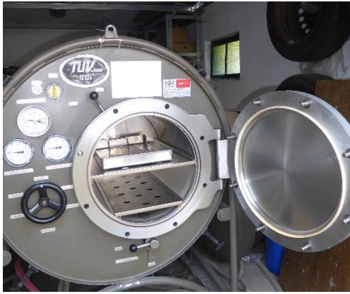
Abbildung 30: Mithilfe des Autoklaven wird das Getreide sterilisiert Foto: Lisa Aigner
