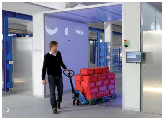
Abbildung 17: Ortsgebundenes (links) und mobiles RFID-Gate (rechts) (Quelle: Schenk, M., [2006]: RFID-Tunnelgate – Die neueste Generation von UHF-RFID-Gates, Fraunhofer Institut für Fabrikbetrieb und –automatisierung, Magdeburg)
