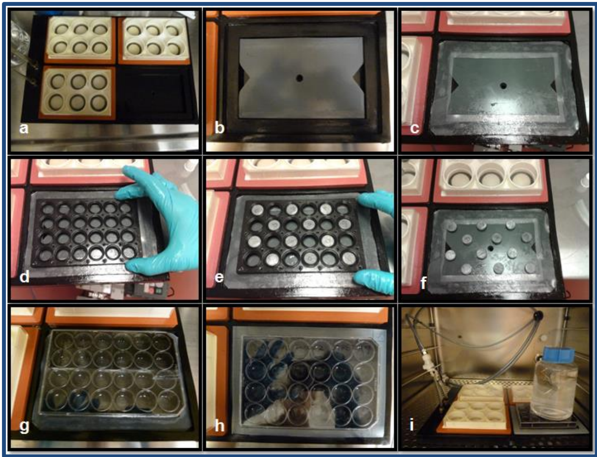
Abbildung 11: Dichtungssystem FX-5000. In die Baseplate (a) wird die Loading Plate (b) eingelegt und die mit reichlich Silikonschmiere eingefette Dichtung 1 aufgelegt (c) . Mithilfe einer Schablone (d) werden die Loading Posts (e und f) in die gewünschte Position gesetzt und die Schablone wieder entfernt. Anschließend werden die HT-Platte (g) und die Dichtung 2 (h) eingesetzt und das Dichtungssystem mithilfe eines schweren Gegenstands fixiert (i) .
