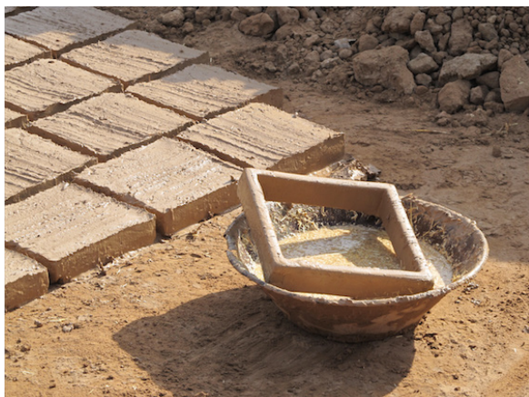
Abb. 70 Mit Holzrahmen geformte Lehmziegel
