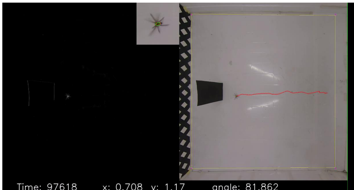
Abbildung 8: Videoaufnahme der Versuchsläufe. Mit Hilfe eines Programms konnte die Position des Tieres während des Laufes erfasst und daraus die genaue Laufspur ermittelt werden. Weitere Bilder der Videoaufnahmen siehe Anhang.
