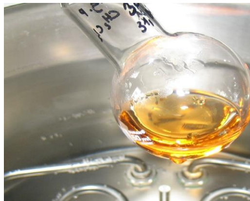
Abb. 15 Abtrennung der organischen Phase im Scheidetrichter und \text{CH}_2\text{Cl}_2 -Abdampfung am Rotavapor
