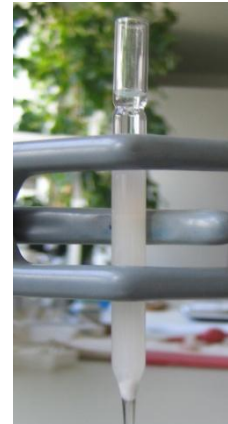
Abb. 16 Kieselgel- reinigung in Pasteurpipette
