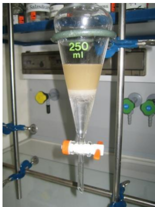
Abb. 15 Abtrennung der organischen Phase im Scheidetrichter und \text{CH}_2\text{Cl}_2 -Abdampfung am Rotavapor
