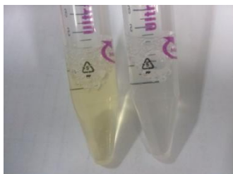
Abb.35: Farbe mit und ohne Lichtschutz, ca. eine Stunde nach Herstellung der Lösung
