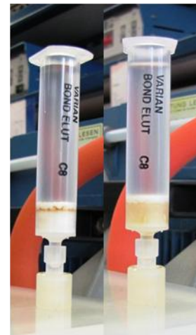
Abb. 5: Aufreinigung des OWE mittels SPE C8 – Phase; Links: Elution mit Wasser, Rechts: Elution mit Methanol
