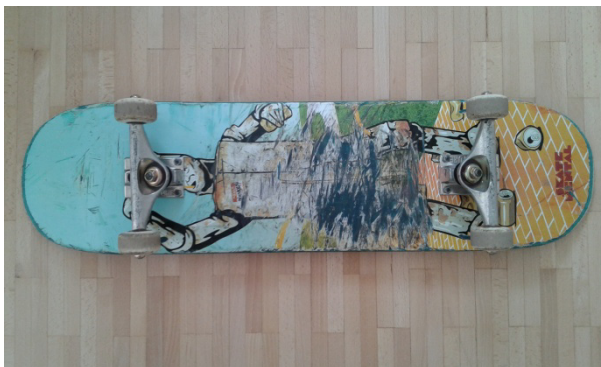
Abb. 2: Deck mit Achsen und Rollen (Unteransicht)
