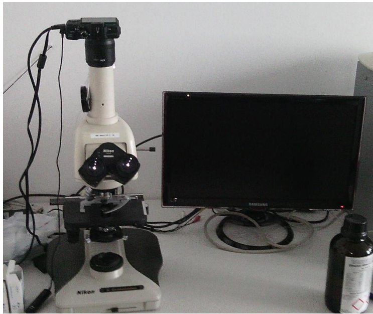
(Abbildung 4: Lichtbildmikroskop mit montierter Kamera und Bildschirmanzeige)
