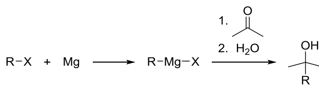
Schema 10: Anordnung einer Grignard-Reaktion.
