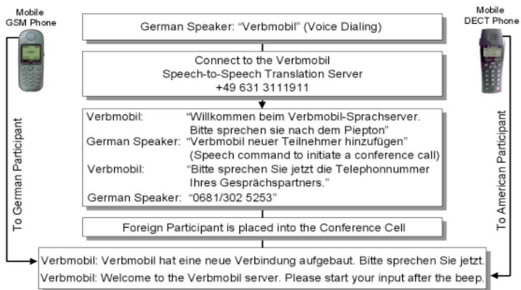
Abbildung 4: Verbindungsaufbau einer Verbmobil-Sitzung (Wahlster 2000: 5)
