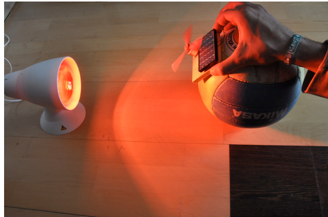
Abb. 4.9: Demonstrationsexperiment 2: Bei konstanter Bestrahlung ist die Drehzahl des mit der Solarzelle verbundenen Rotors auf der gekrümmten Oberfläche abhängig vom Einfallswinkel. Quelle: Eigenes Bild
