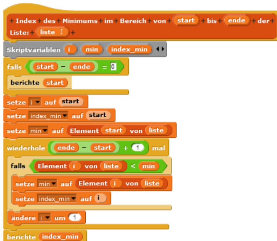
Abbildung 65: Hilfsfunktion: Ermittelt den Index des Minimums einer Liste in einem bestimmten Bereich
