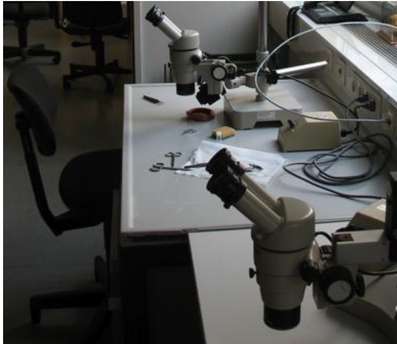
Abbildung 2: Arbeitstisch für die Präparation: Auflichtmikroskop, darunter eine Petrischale mit Korkboden und Gummiring sowie Präparierbesteck
