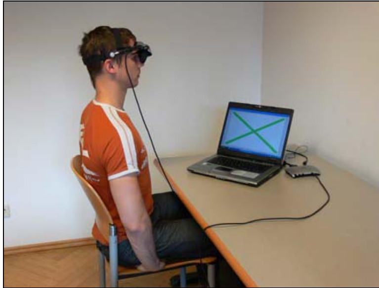
Abbildung 24: Der Verfasser beim Üben mit dem eMagin Sytem mit Z800 3D Visor und Controller, Fa. eMagin inkl. 2 SVGA-Monitoren, Controller Head Tracker, Okulare, Stereoanschlüsse, stereo Earbuds und Riemen.
